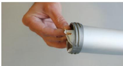
**7** Uistite sa, že celé vrečko Skamol Glue je vo vnútri pištole Skamol Glue Pistol.
