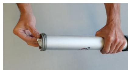
**6** Vrečko na lepidlo Skamol Glue otočte tak, aby sa ľahko zmestilo do pištole Skamol Glue.
