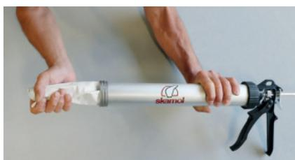
**5** Vložte vrečko Skamol Glue do pištole na lepidlo Skamol Glue Pistol. Malá dierka musí smerovať k otvoru.
